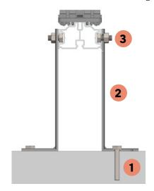
La mise en contrainte de l'ensemble se fait par le biais de l'organe de fixation
