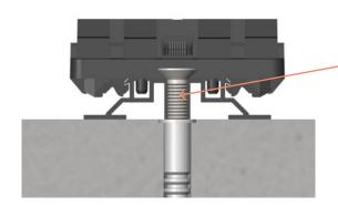
La mise en contrainte de l'ensemble se fait par le biais de l'organe de fixation
